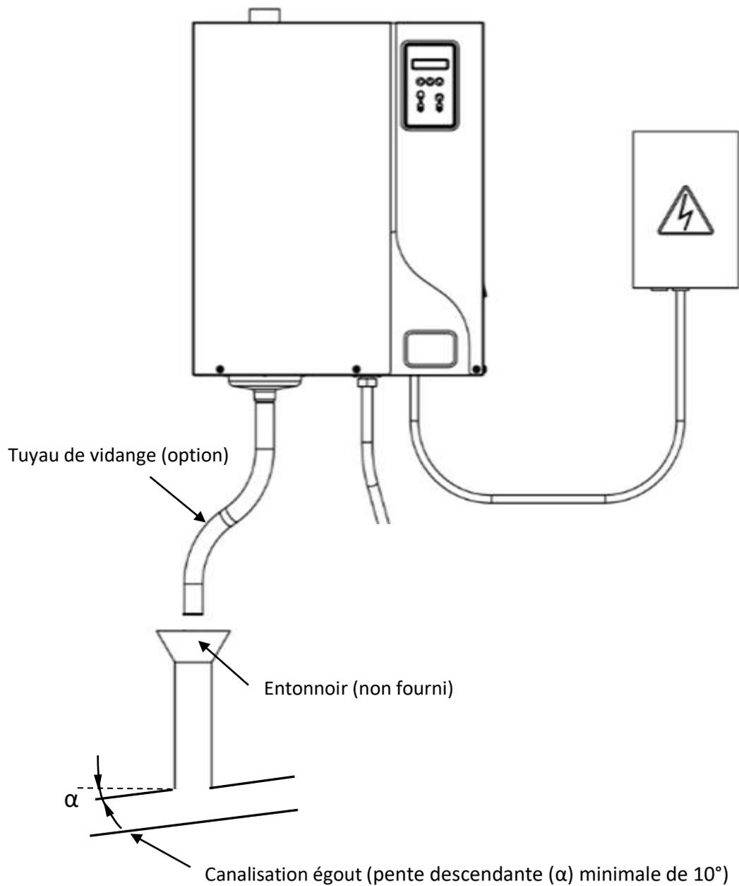
Fig. B 3-5. Exemple d'installation avec entonnoir
