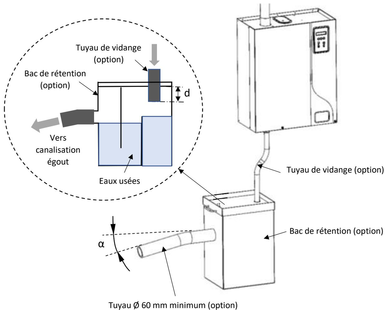
Fig. A 3-5. Exemple d'installation avec bac de rétention
