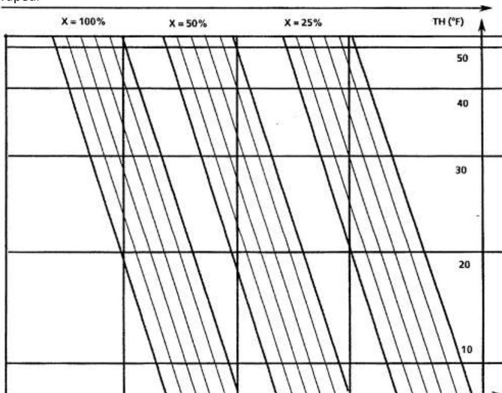
Exemple : Pour un générateur fonctionnant à 100% de sa capacité, utilisant de l'eau avec un TH20, le cylindre vous devra être nettoyé ou changé après 800-900 heures de fonctionnement :
